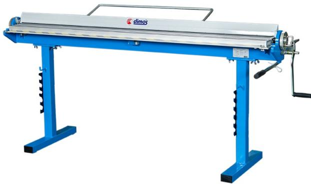
Mit den Biegewangen können Metallbleche mit Durchmessern von 13 bis 25 mm gesäumt werden.
